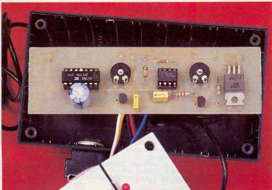
Photo 5. – Carte supérieure du flash téléphonique (le condensateur C7 n'est pas placé).
