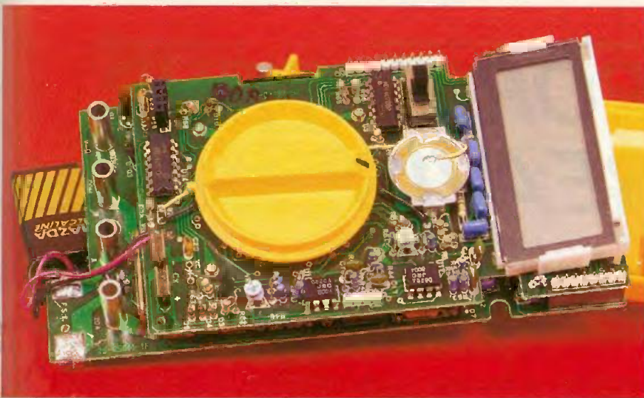
Photo 2. - La structure interne de l'appareil révèle l'utilisation de deux circuits imprimés.
