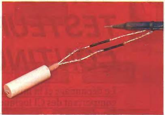
Prolongation des fils d'alimentation secteur.
