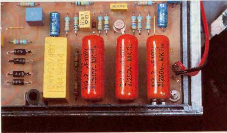
Photo 4 - La batterie de condensateurs.
