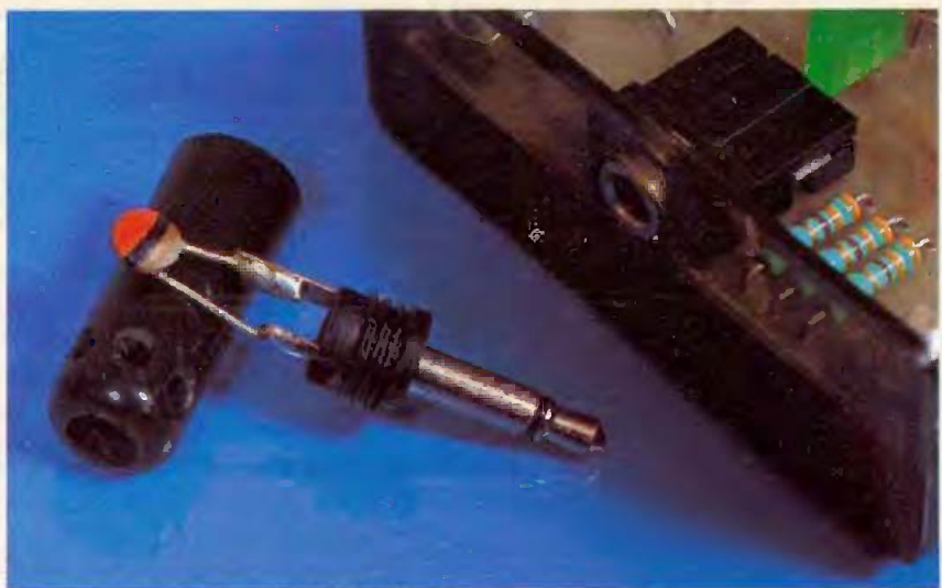
Le capteur : une résistance CTN de 10 K \Omega .
