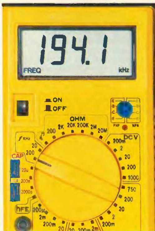
Photo 2. — Le grand commutateur rotatif, qui sélectionne gammes et fonctions, élimine les risques d'erreurs. On remarque les contacts pour les transistors et pour les condensateurs.
