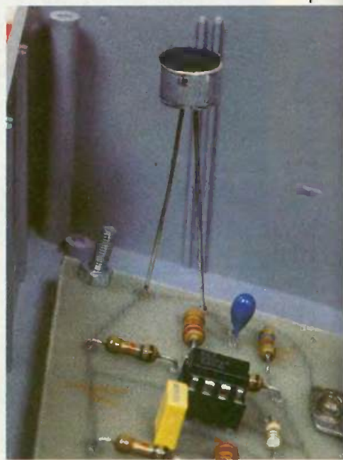
Fig. 2 Schéma de principe. Aspect du micro « électret ».
