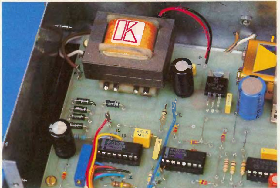
Photo 4. - Section alimentation avec son circuit régulateur.
