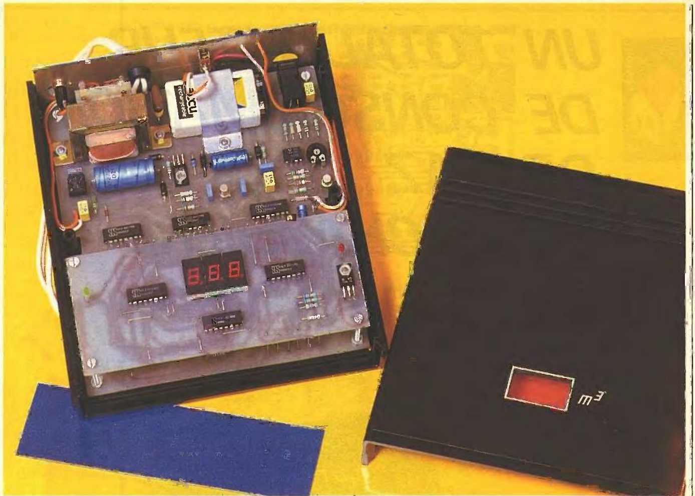
On distingue la carte imprimée principale surmontée du circuit d'affichage.
