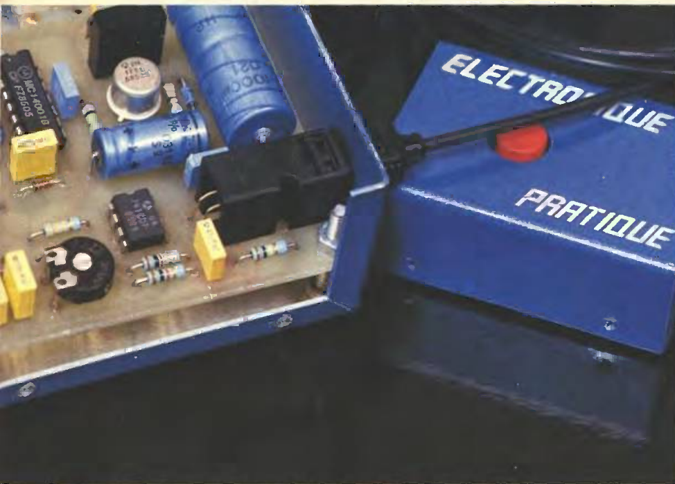
Photo 4. - Couplage fibre optique par connecteur « Hirschmann ».
