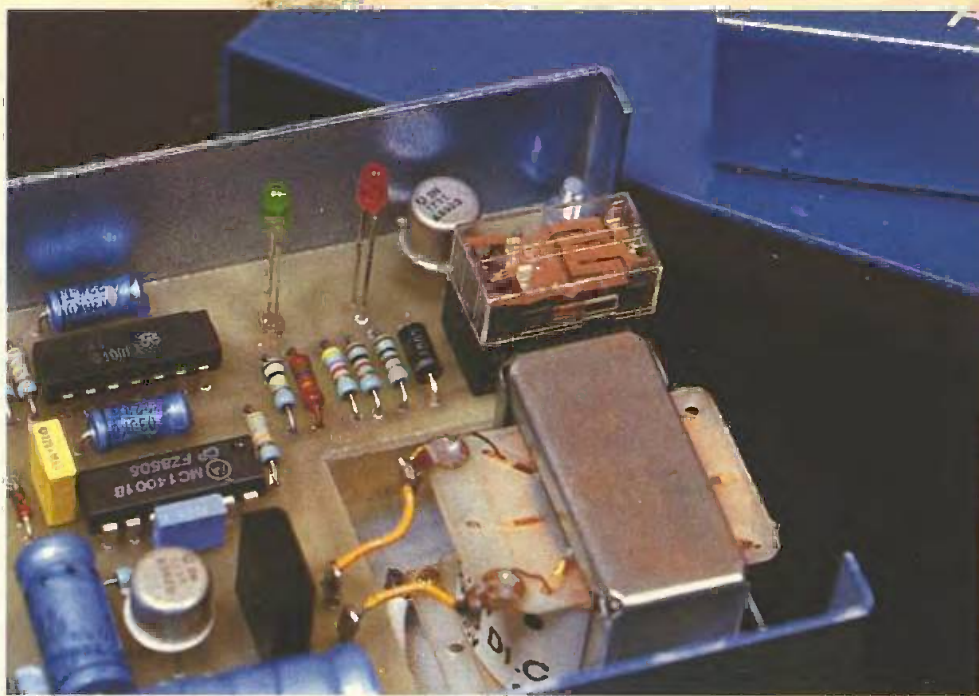
Photo 3. - Le relais et les deux LED d'état de fonctionnement.
