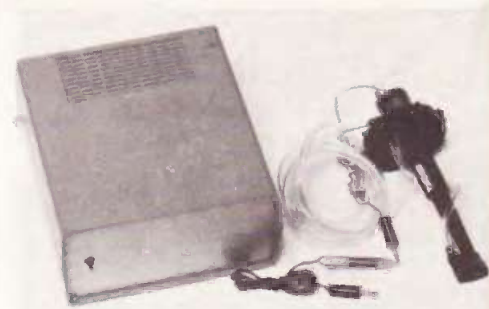
Photo 5. — Le boîtier Teko, et la pompe de lave-glace de marque Renault.
