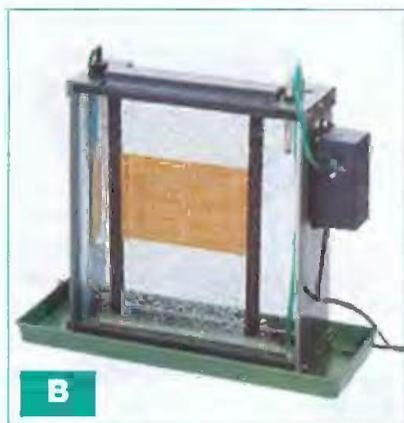
orienté vers le haut. L'appareil génère des bulles d'air au sein du liquide grâce à une pompe semblable à celles qui oxygènent les aquariums. Il en résulte l'écoulement, le long de ce plan incliné, d'une écume jaunâtre qui grave le circuit.
