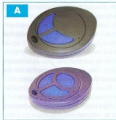
◆ **L'émetteur** est du type porte-clés. C'est un HCS-TX2 (photo A) de chez Aurel. Avec une à trois voies disponibles, il nous faudra ici au moins deux boutons pour exploiter toutes les possibilités du montage. Il émet sur la bande des 434 MHz, un code binaire à chaque fois différent et issu de l'algorithme à haute sécurité Keeloq (de Microchip). Chaque boîtier est en fait doté d'un numéro de série unique de 28 bits, d'une clé de
