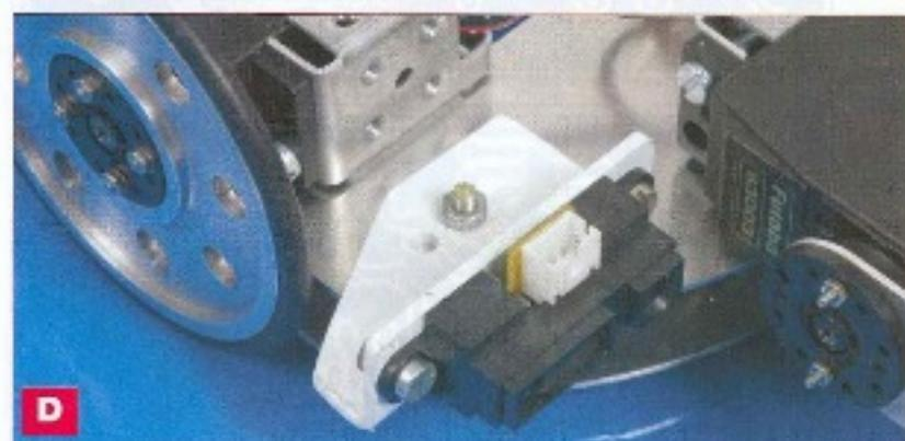
La carte est fixée au châssis en aluminium par quatre vis M3 et quatre entretoises M3 de 5 mm.
