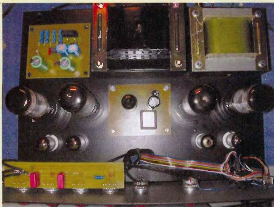
Photo 4 : le module de réverbération positionné sur le châssis
