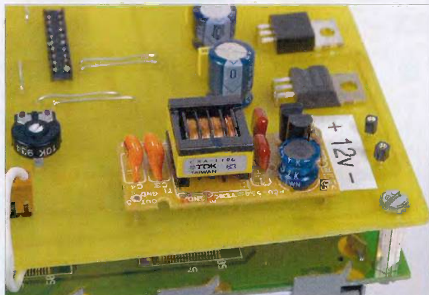
Module élévateur de tension (100 V) à partir d'un + 12 V
