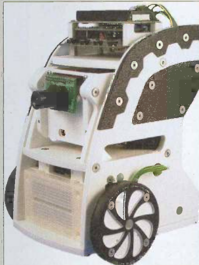
Le Botster avec son châssis mobile en polycarbonate, sa motricité est assurée par 2 servo-moteurs
