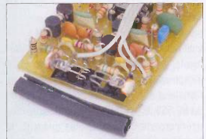
Constitution des photo coupleurs, un film adhésif noir empêche la pénétration de la lumière au travers du circuit imprimé. Les boucles des sorties des diodes permettent un réglage de leur position par rapport à la photorésistance (équilibrage)
