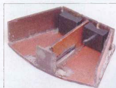
Détail du capteur réalisé en stratifié verre époxy de 0,3 mm
