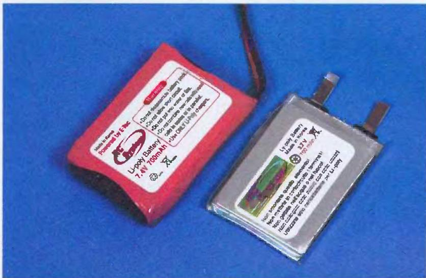
La batterie de gauche est constituée de deux éléments, les batteries du commerce contiennent un circuit de protection de l'accumulateur.
