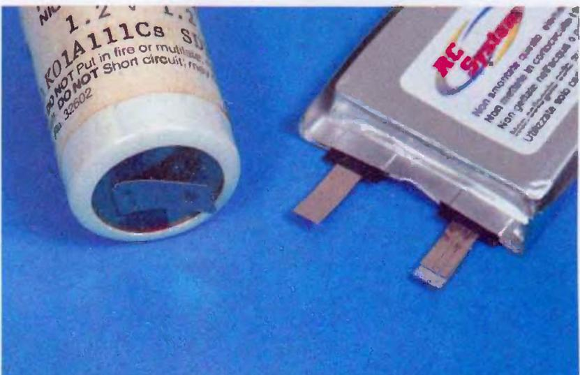
Détail des sorties d'accu, sur l'accu Ni-Cd, la patte est soudée sur le métal de l'accu, sur l'accu Li-Po, on a mis une bande soudable sur une patte d'aluminium, une matière plastique noire isole les pattes, il faut éviter de la faire fondre lors de la soudure... Par ailleurs, leur finesse les rend fragiles.
