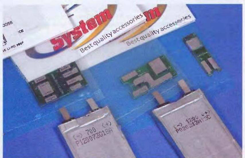
**Si vous achetez des éléments séparés, vous pourrez aussi vous procurer des plaquettes de connexions, circuits imprimés permettant les liaisons séries ou parallèles de plusieurs éléments. Le pas ne change pas avec la capacité de l'accu.**
