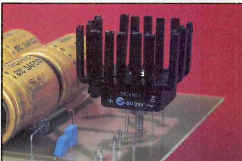
le pont de 25A et son dissipateur
