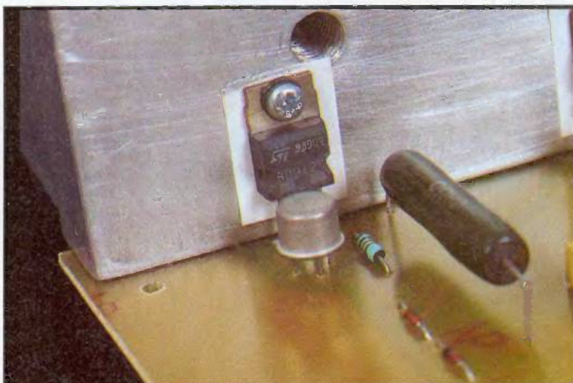
le BD 912 (PNP plaqué contre le dissipateur)
