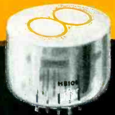
Haydu Numerical Indicator Tube "Nixie"
