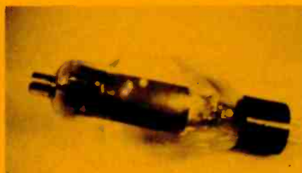
Fig. 13 A larger type of thyratron.
