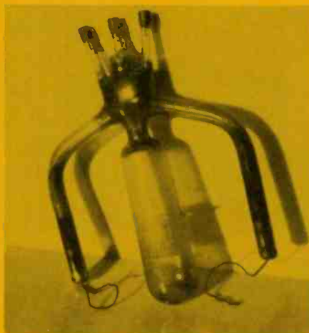
Fig. 3 A Cooper Hewitt mercury-arc rectifier tube.
