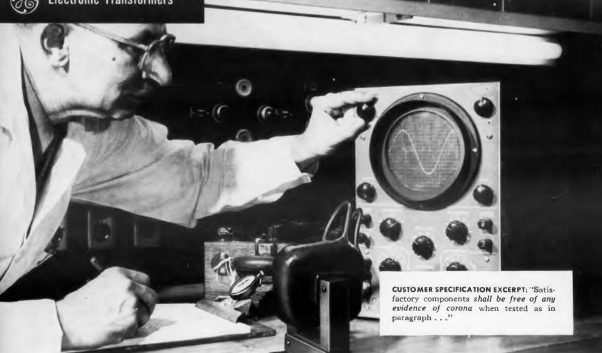
UNDER CUSTOMER-SPECIFIED TESTS, OSCILLOSCOPE POWER WAVE SHOWS TRANSFORMER WINDING TO BE FREE OF ANY EVIDENCE OF CORONA
