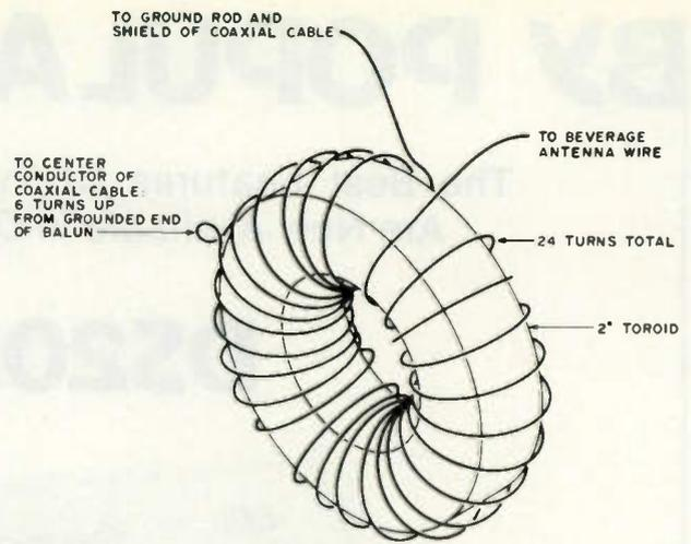
Fig. 2. A homemade 4:1 balun.
