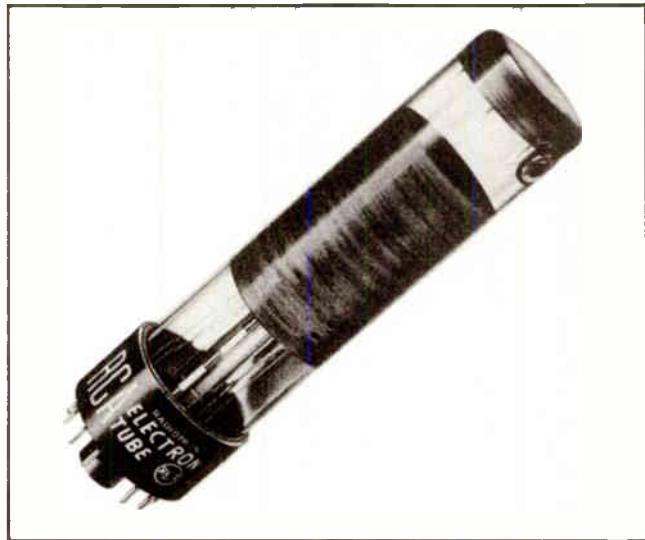
Fig. 14. An Image Orthicon.
