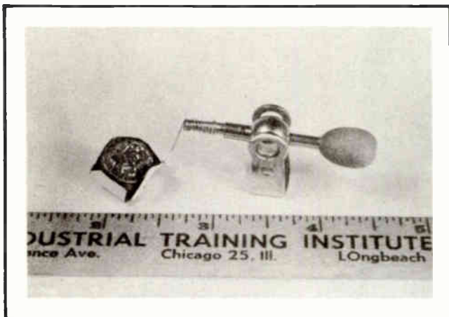
Fig. 8. A Rectifying Crystal.
