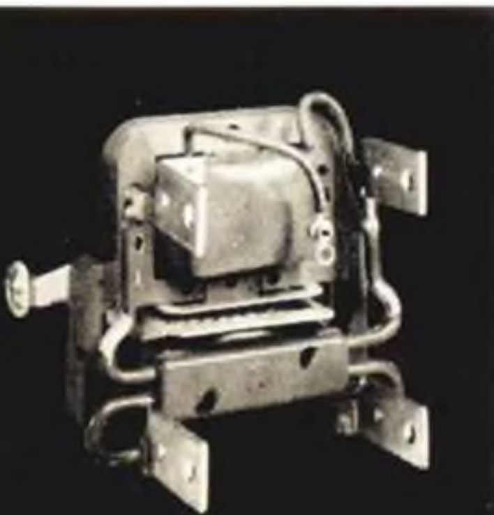
Izquierda, conjunto del electroimán del contador DS, mostrando las bobinas de corriente aisladas con poliéster y arrolladas en molde. Der., conjunto del contador CS; véanse las bobinas arrolladas a mano.
