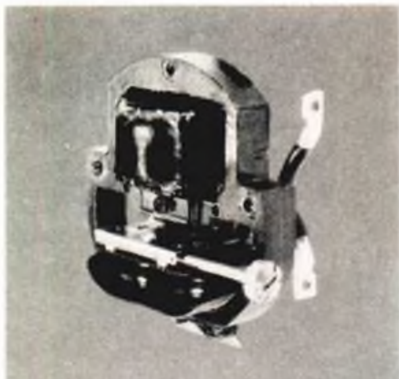
Izquierda, conjunto del electroimán del contador DS, mostrando las bobinas de corriente aisladas con poliéster y arrolladas en molde. Der., conjunto del contador CS; véanse las bobinas arrolladas a mano.
