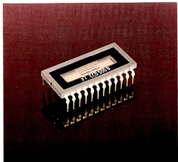
The P 2 CCD 500B linear imager
