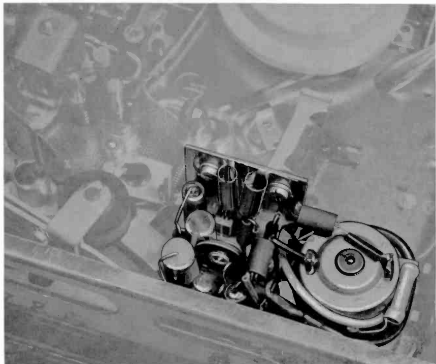
Bild 20 Aufbau des HF-Oszillators und der Regeltransistorstufe im Tonbandkoffer TK 6. Rechts ist der Motor zu sehen
