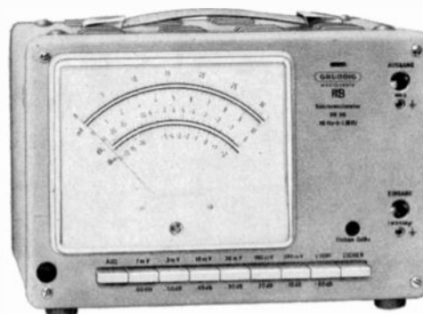
Bild 14 GRUNDIG Röhrenvoltmeter RV 56. Alle technischen Daten wollen Sie bitte unserem Meßgeräte-katalog entnehmen. Eine ausführliche Beschreibung wurde in der „FUNK-TECHNIK“, Heft 2/1963, Seiten 41... 45, veröffentlicht.
