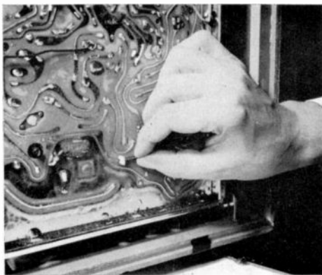
① Herausziehen eines Hartpapier-Arretierkeils auf der Lötseite der Chassisplatte,
