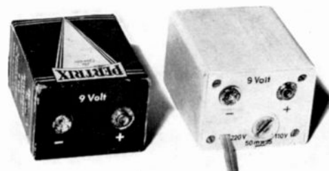
Bild 18 Transistor-Netzteil 9 Volt in der Größe einer „Power-Block“-Batterie, geeignet für zahlreiche neue und auch ältere Transistor-Reisesuper
