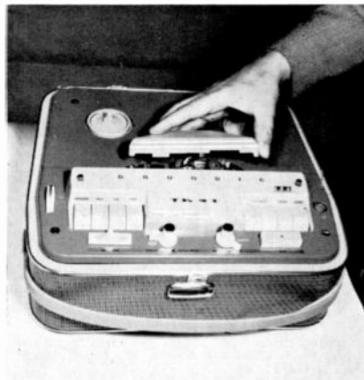
So leicht ist die Kopfabdeckkappe abzunehmen
