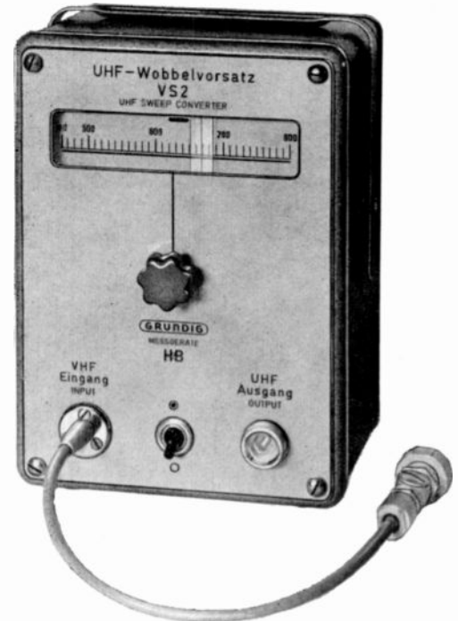
Mit dem GRUNDIG UHF-Wobbelvorsatz VS 2 können alle vorhandenen Fernseh-Meßgeräte (Wobbler, Bildmustersgeneratoren) auf UHF erweitert werden.
