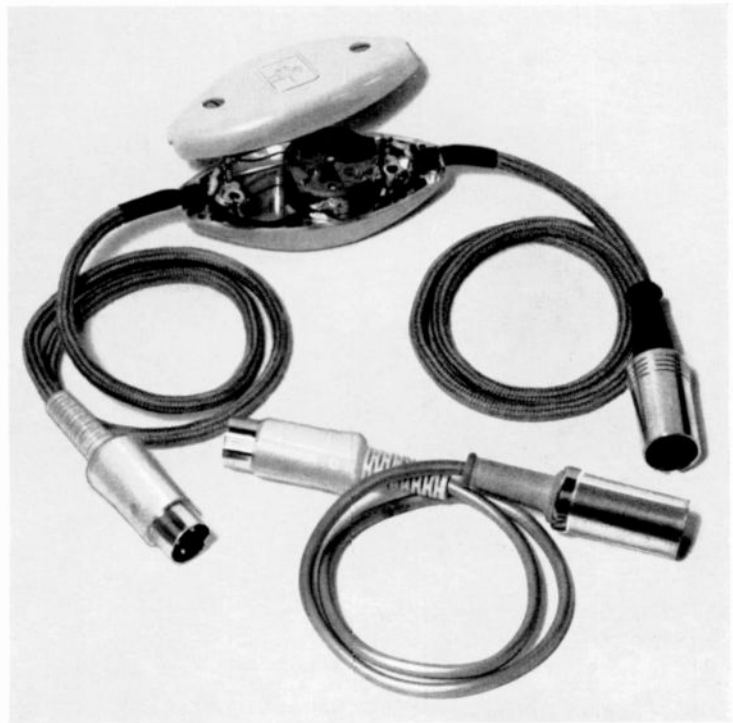
Bild 1 Oben: Das bisherige Mikrofon-Verlängerungskabel mit Schnurübertrager darunter: Das neue Mikrofon-Verlängerungskabel mit Stecker-Übertrager
