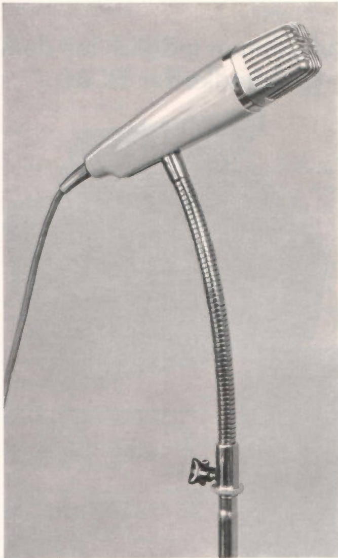
Bild 11 Bündchen-Richtmikrofon GBM 125 mit Schwanenhols MSH 20 auf Stotiv S 15.
