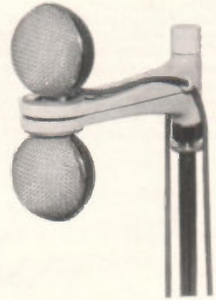
Bild 9 c Mikrofon GDSM 211, eingestellt für Nur-Mitteneindruck (beide Kapseln nach vorn gerichtet)
