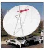
4.5-Meter C-, X- or Ku-Band Transportable Antenna
