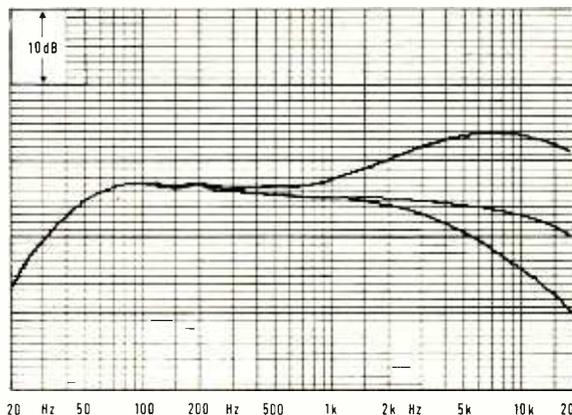
FIG.3 FOSTEX B-16 RECORD EQUALISER RANGE
