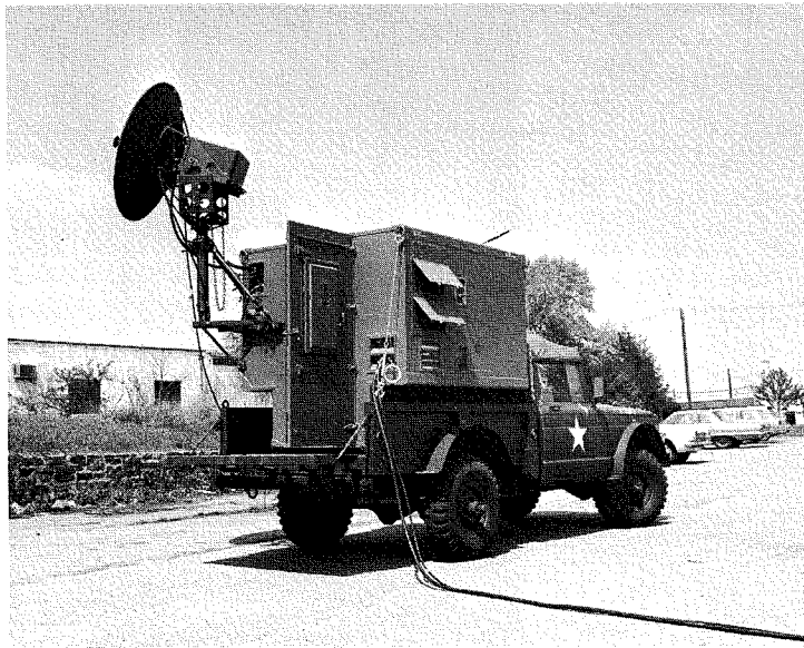
Fig. 6—AN/TSC-80 shelter terminal.
